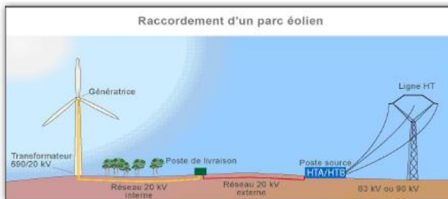
Figure 21 : Organisation générale du raccordement électrique au réseau de distribution Source : EIE, ENCIS Environnement
